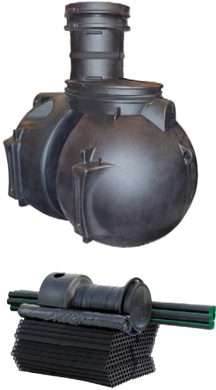
Kuvissa 1 m 3 saostussäiliö ja imeytysmoduulipaketti 6 harmaille vesille. Verkkoputkista rakennetut imeytysmoduulit korvaavat jakokerroksen ja ne puhdistavat jätevettä tehokkaammin kuin perinteinen sepelikerros.
