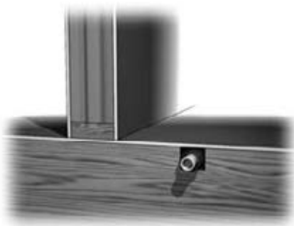
Esimerkki putkien sijoittamisesta väliseinän viereen.
